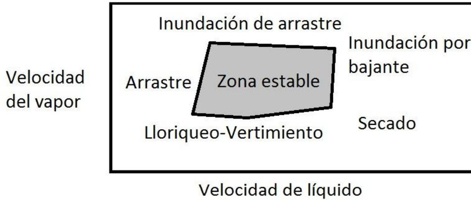
Ilustración 35. Regiones de operabilidad de acuerdo a la velocidad del vapor y del líquido
